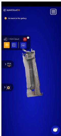
El tablero desplegable superior muestra la opción de cambiar a visión de nube de puntos o malla poligonal.
