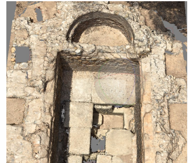
Nuvem de pontos densificada, com a triangulação de novos pontos em relação e sobre a nuvem antiga.
