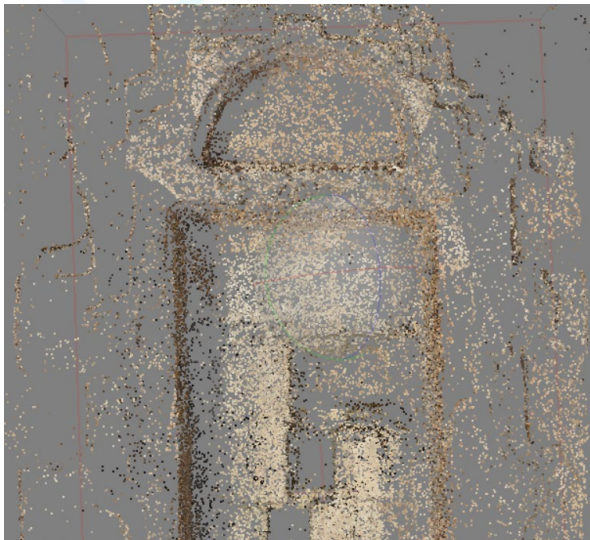
Primeira nuvem de pontos, resultante do alinhamento das imagens processadas.
