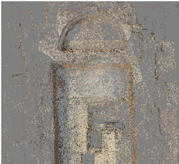
Primera nube de puntos, resultante de la alineación de las imágenes procesadas.
