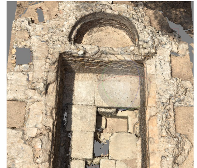
Nube de puntos densificada, mediante la triangulación de nuevos puntos en relación y sobre la nube anterior.
