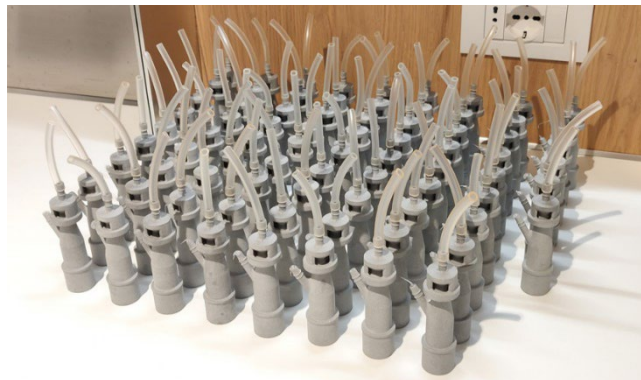
Válvulas impresas en 3D. Fuente: 3DNatives.
