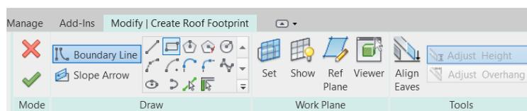
Com a ferramenta *Rectangle*, desenhar um retângulo clicando na face interior das paredes. Seleccionar a linha inferior e movê-la 0,125 m para o interior em relação à parede, para deixar espaço para a calha, de modo que fique como na figura abaixo.
