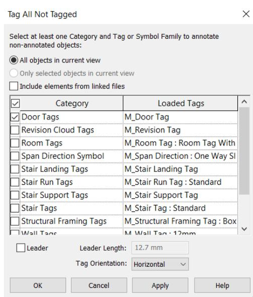
Após clicar em OK, pode-se constatar que foram inseridas etiquetas em todos os elementos da vista (realizar o mesmo processo para as vistas *Basement* e *Ground Floor*).
